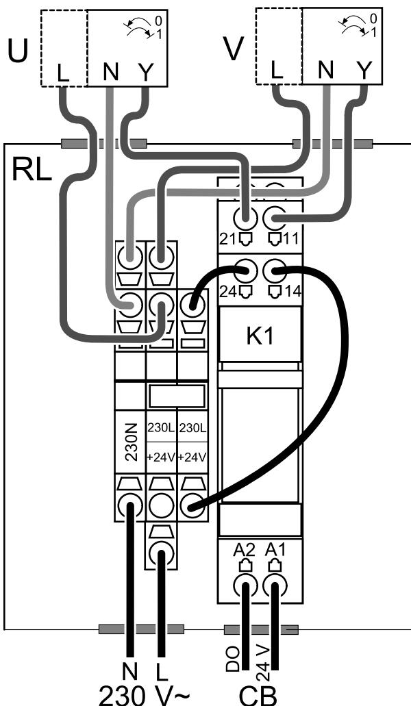
Рис. 19 Подключение клапана
