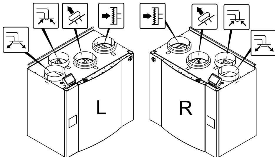
Рис. 3 Соединения воздуховодов
