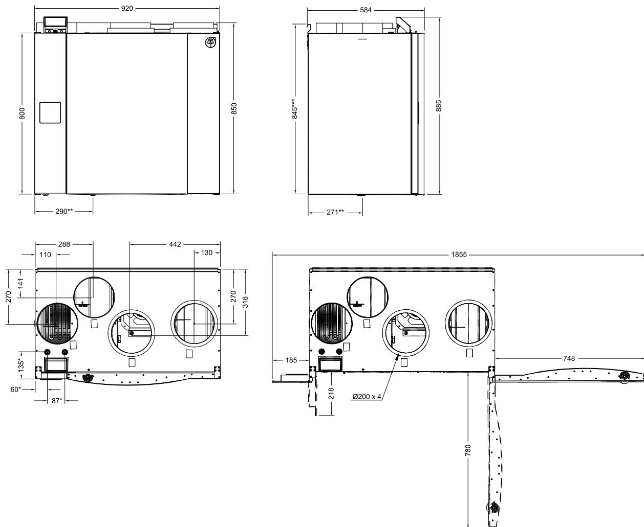
Рис. 1 Размеры и вес левосторонней модели (L)
