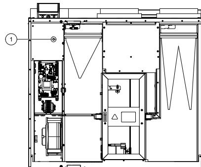
Рис. 12 Кнопка сброса защиты от перегрева
