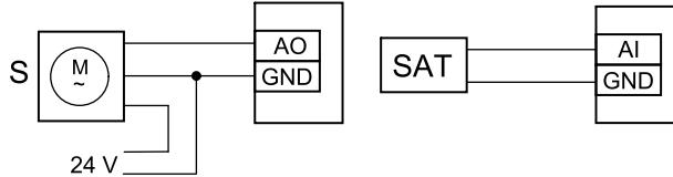
Рис. 17 Соединения канального охладителя
