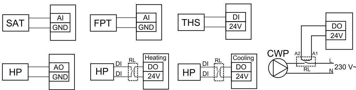
Рис. 18 Подключения переменного теплообменника холод/тепло
