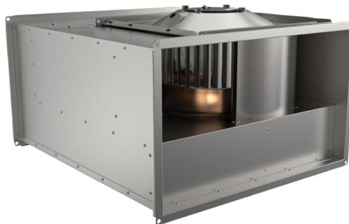
**Двигатель:** Вентиляторы данной серии оборудованы электродвигателями с внешним ротором и рабочим колесом с загнутыми вперед лопатками. Для защиты электродвигателя от перегрева вентиляторы оснащены встроенными термисторами (PTC - положительный температурный коэффициент) с выводами для подключения к внешнему устройству защиты U-EK230E.
